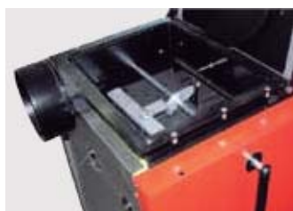
SISTEMA DE LIMPIEZA DEL INTERCAMBIADOR EXTERIOR CON LEVA EXTERIOR.
