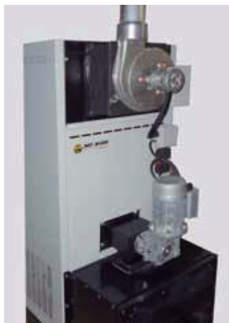
EXTRACTOR DE HUMOS EN LA PARTE POSTERIOR PARA ASEGURAR UNA CORRECTA DEPRESIÓN DE LA CÁMARA.
